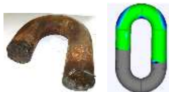
Photo d'une partie du maillon cassé et modélisation numérique de la déformation
